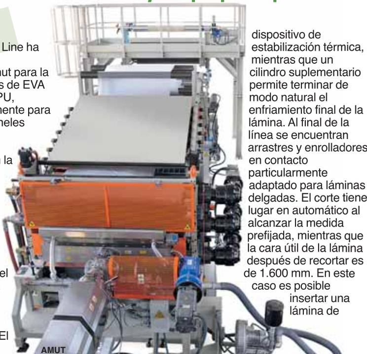
dispositivo de estabilización térmica, mientras que un cilindro suplementario permite terminar de modo natural el enfriamiento final de la lámina. Al final de la línea se encuentran arrastres y enrolladores en contacto particularmente adaptado para láminas delgadas. El corte tiene lugar en automático al alcanzar la medida prefijada, mientras que la cara útil de la lámina después de recortar es de 1.600 mm. En este caso es posible insertar una lámina de
